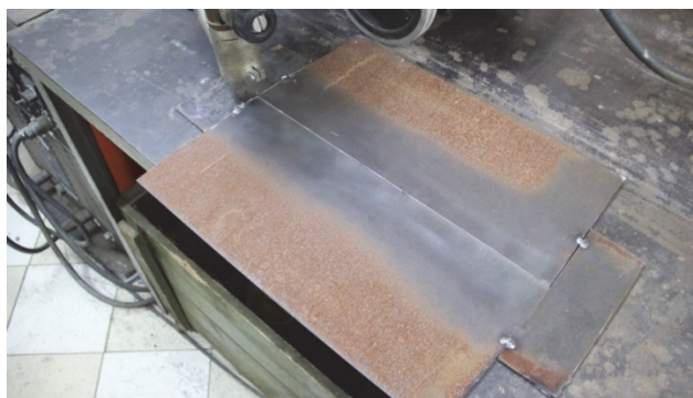
Рисунок 1 – Собранный под сварку образец
