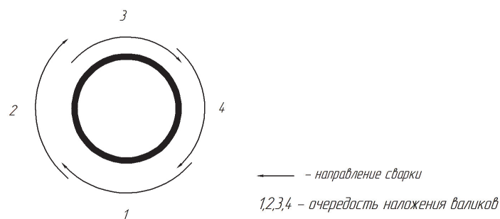
Рисунок 1 – Наложения сварочных валиков
