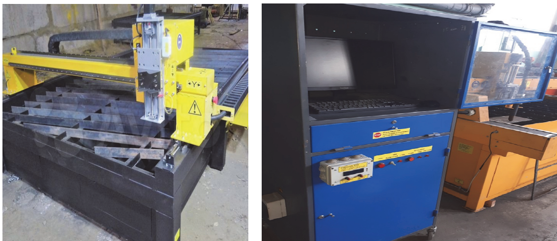
Рисунок 1 – Станок для автоматизированной плазменной резки
