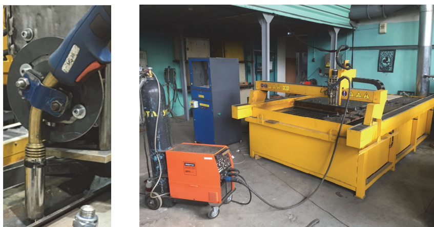
Рисунок 1. Кронштейн крепления сварочной горелки и схема комплектации станка для дуговой наплавки
