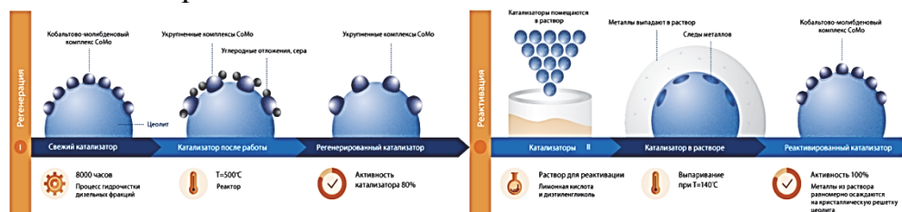
Рисунок 1 – Регенерация катализаторов на примере кобальто-молибденового комплекса
