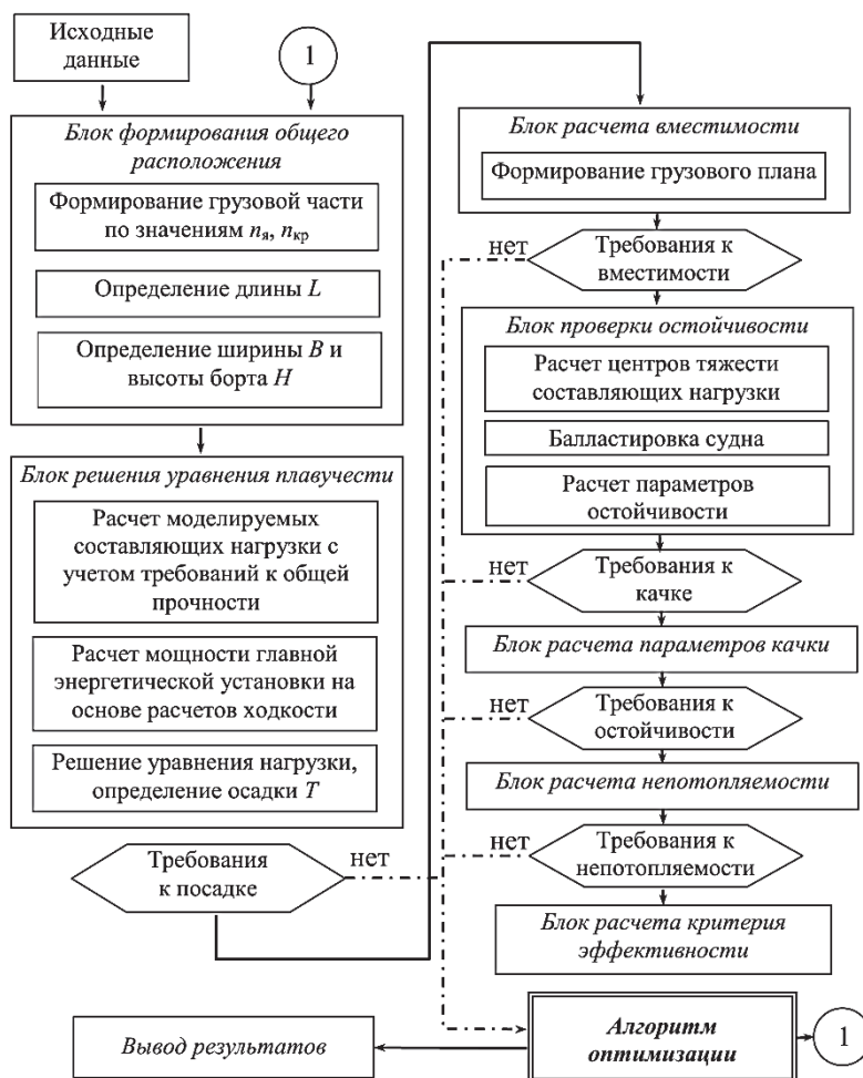
Рисунок 2 – Обобщенная математическая модель оптимизационного проектирования контейнеровоза
